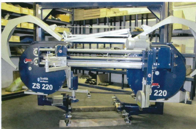
Ein Exot unter den stationären Blockbandsägen ist die ZS 220 S mit einem Durchgang von 220 cm x 183 cm. Die vor allem für den Einschnitt von starkem Tropenholz konzipierte Säge hat eine Breite von 4 m, eine maximale Schnitttiefe von 55 cm und einen Antriebsmotor mit 30 kW
