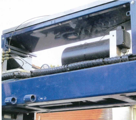
Der Kettendreher mit Stern der ZS160 S zeigt seine Stärke vor allem beim präzisen Positionieren von übergroßen Stämmen
