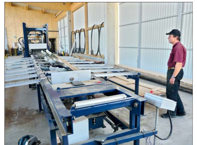
...oder nach links. Wenn man den Anschlag am Ende der Rollenbahn absenkt, können sogar 14 m lange Furniere und Bretter geschnitten werden.
