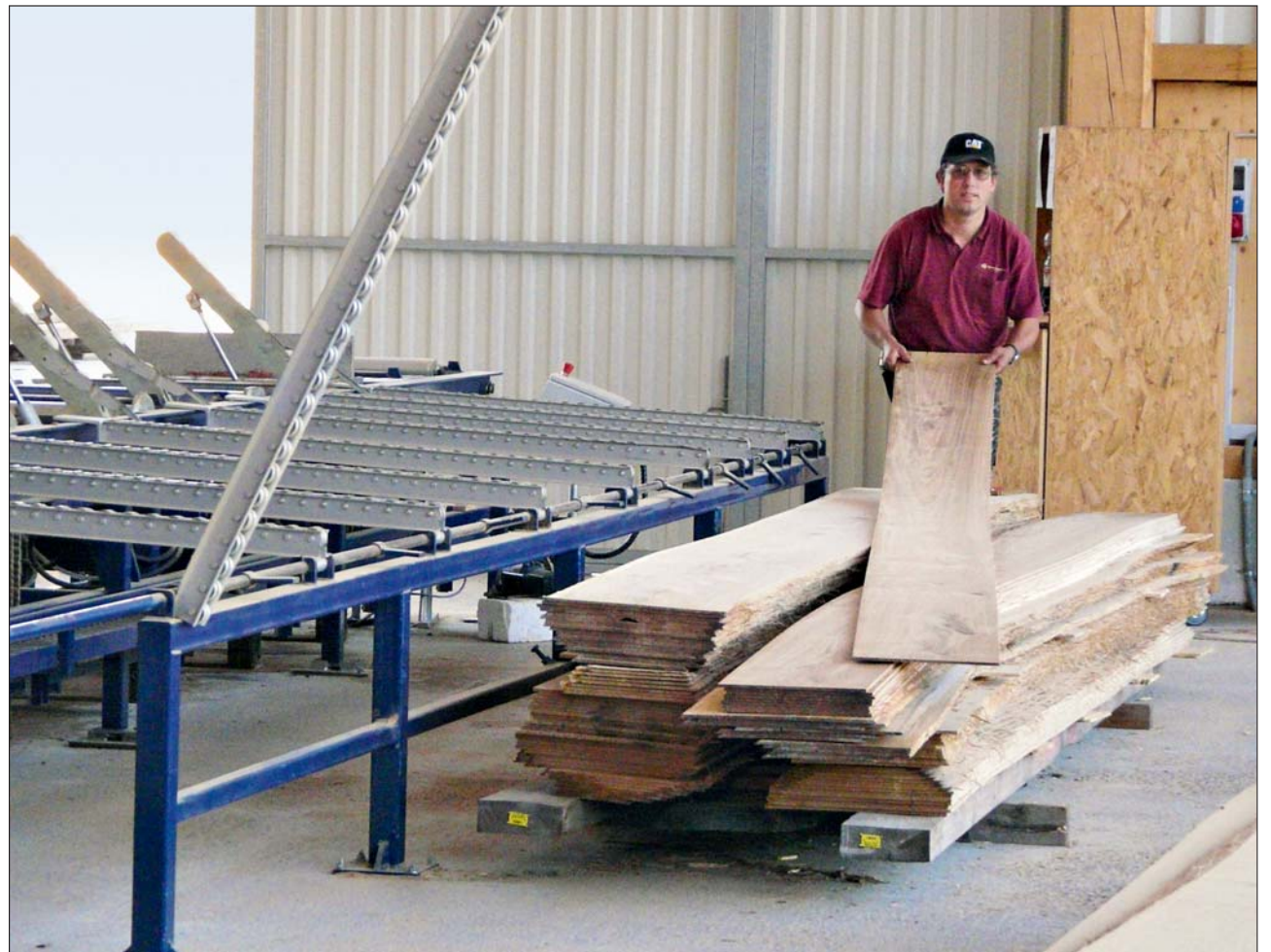
Der Sägenbediener hat drei Leitstände zur Verfügung, von denen aus er die Anlage bedient. Sie läuft weitgehend automatisch, so dass er sich auf die Qualitätsansprüche und entsprechende Sortierung kümmern kann. Fotos: L. Pirson
