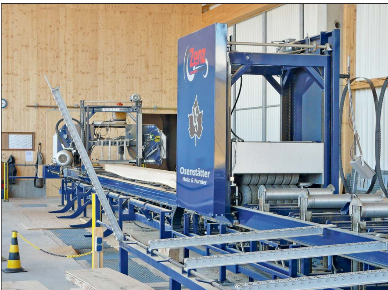
Vorder- und Mittelteil der Blockbandsägenanlage. Links im Hintergrund der Kopf der Horizontal-Breitbandsäge, in Bildmitte der Ständer mit der Vorschub- und Bürsteneinheit, die die Bretter vom Sägemehl befreit.
