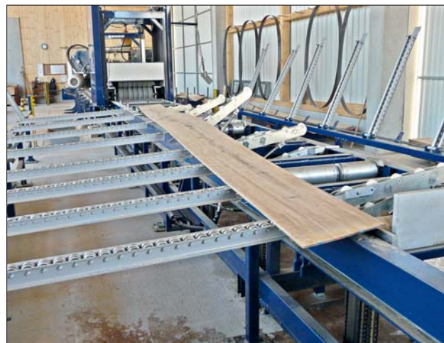
Ausgebaute Fördertechnik im hinteren Teil der Blockbandsäge: Die Sägefurniere oder Brettwaren können nach rechts abgestapelt werden...
