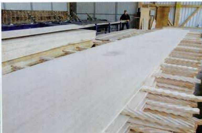
Mit der Wimmer-Säge werden breite, lange und feine Sägefurniere geschnitten
