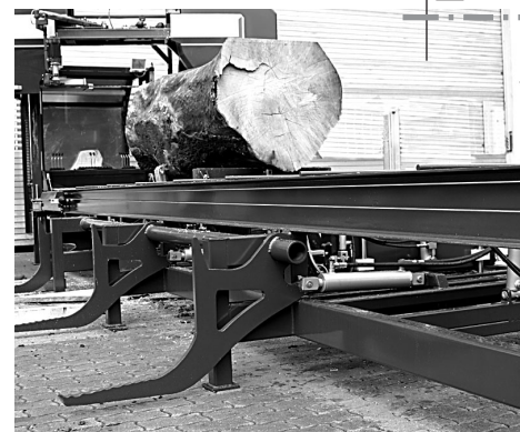
Grundrahmen aus Doppel-T-Trägern mit massivem Unterzug
