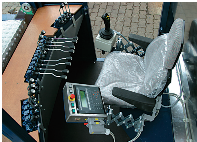
Innenraum der BN 150-Kabine mit SPS-Steuerung: bedient wird mit Joystick
